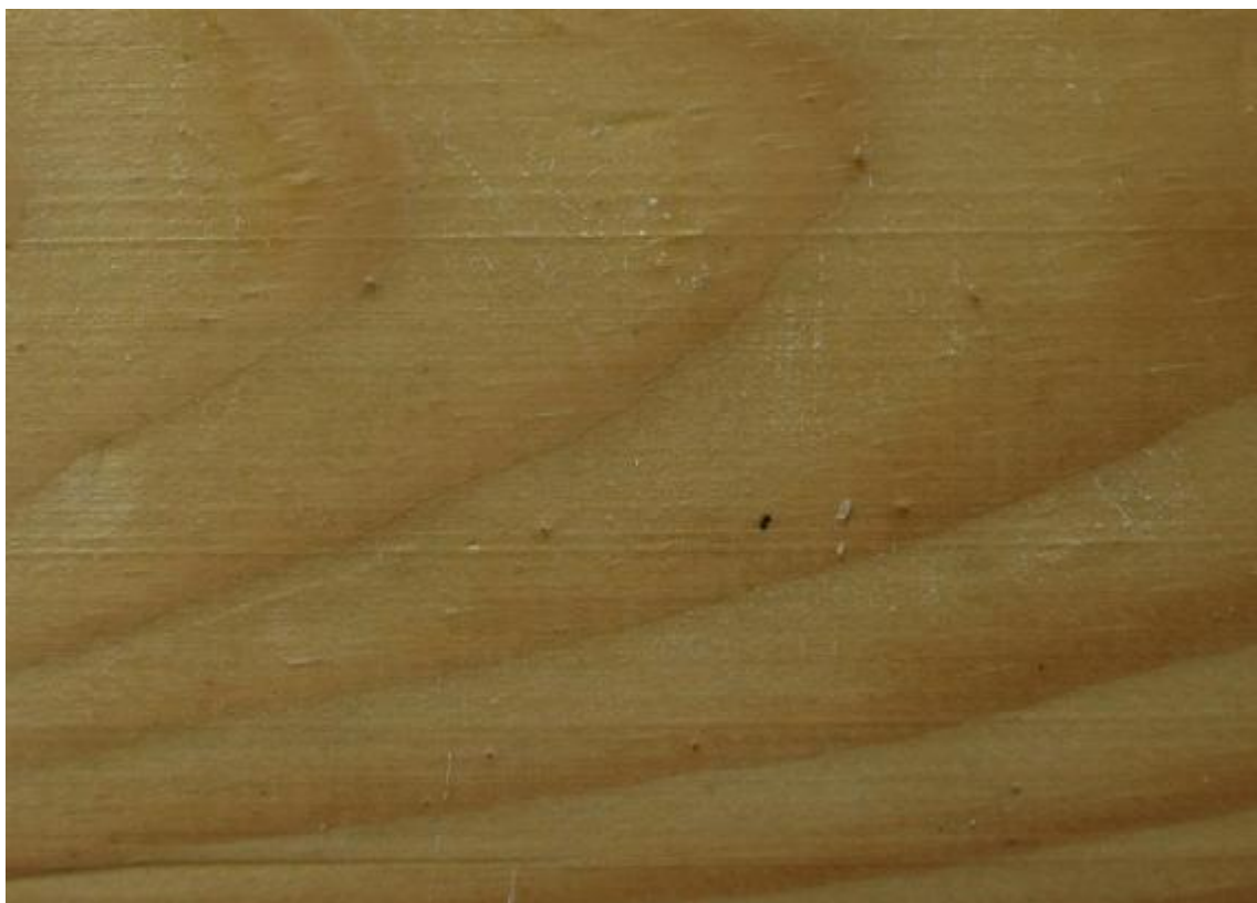
Zdjęcie 7. Powierzchnia zabezpieczona prawidłowo
